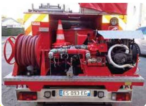
Nouvelle pompe du VPI
